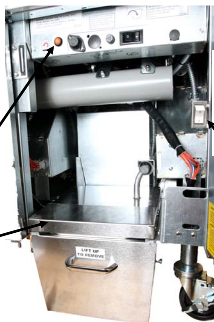
Figura 3: Ligue o conector preto na caixa de utilidade como mostrado. Um chicote de fios separados com uma ficha branca, se presente, não é usado.
