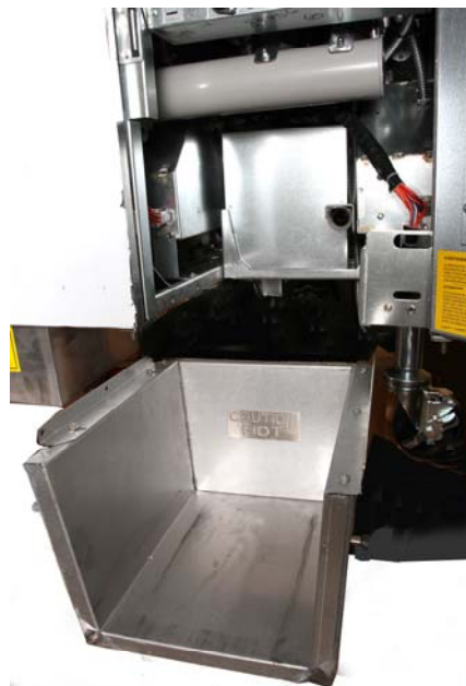
Figura 1: Posicione o aparelho de fusão no gabinete e prenda com parafusos fornecidos para o interior do armário.
